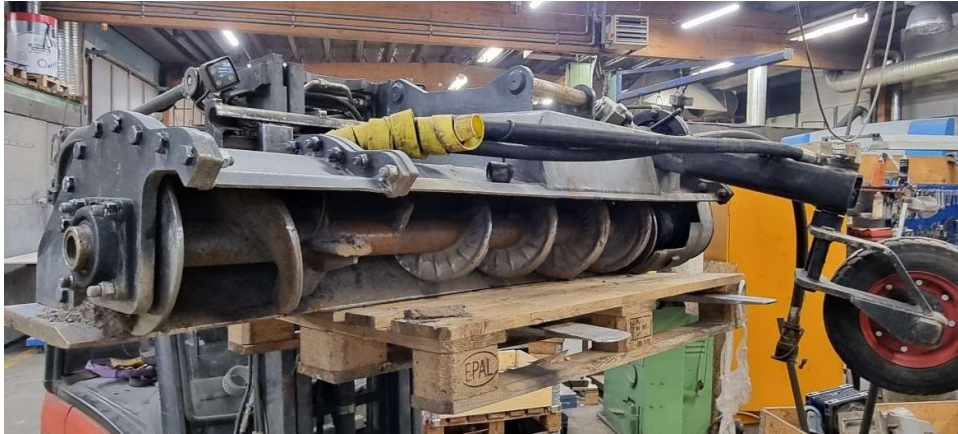
Bild 3 Tredje prototypen nu med en förlängning utav skruven med 30cm
