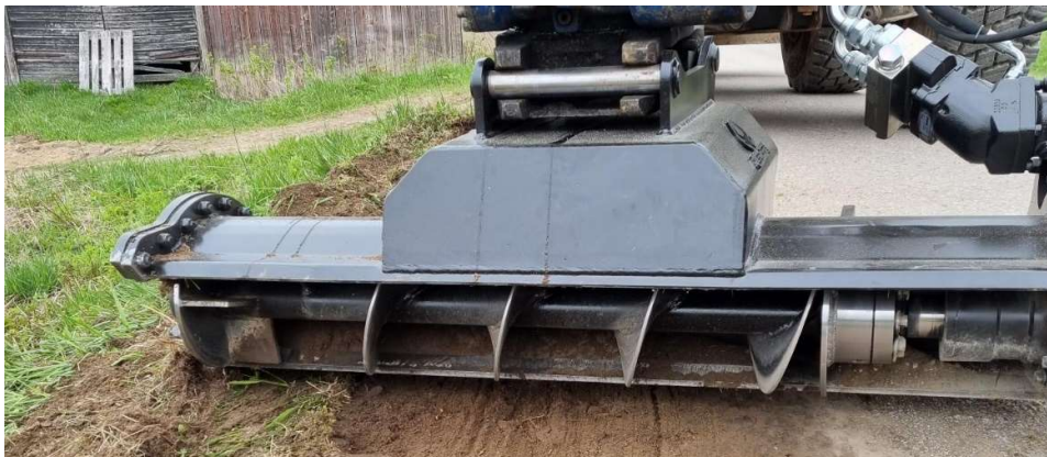
Bild 2 Första prototypen av kantskruv
